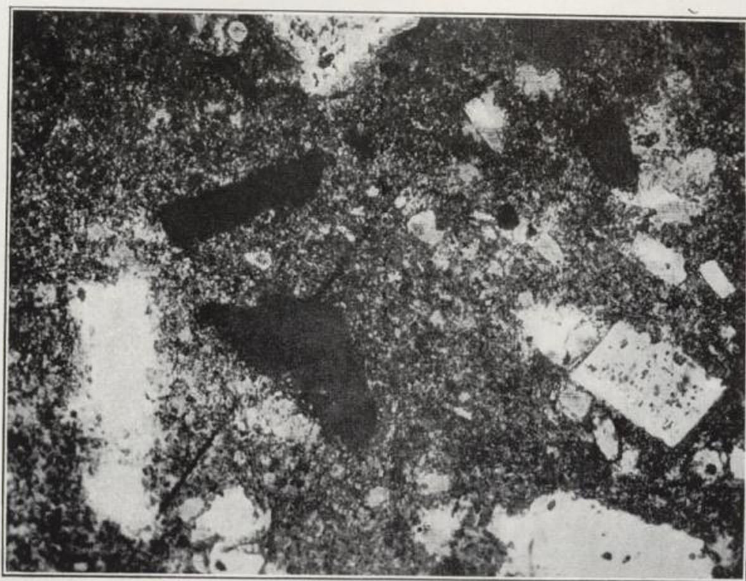
Fig. 34. — Andesita con biotita y hornablenda recogida en la carretera y en sitio próximo al campamento de Kaddur.
